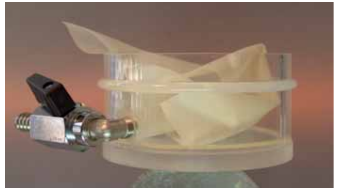
Abb. 11 Der Metavac Tiefziehbehälter sorgt dafür, dass sich komplexere Modellationen optimal und schonend am Meistermodell adaptieren.
