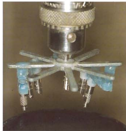
Abb. 48 und 49 Umsetzen der Primärstruktur auf das Fräsmodell. Die definierte Einschubrichtung bleibt erhalten.
