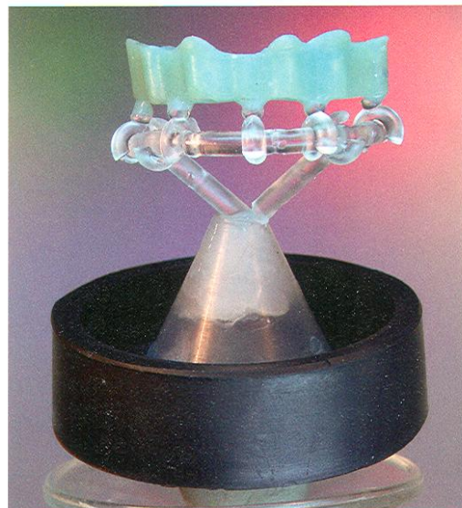
Abb. 26 Die primo-click-Zuführungsclips werden an den „dicken“ Stellen der Modellation positioniert, denn dort wird die Schmelze beim Abkühlen Legierung nachfordern
