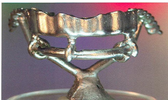
Abb. 39 Wiederum im Speed-Verfahren gegossen: die fertig ausgebettete und abgestrahlte Tertiärstruktur
