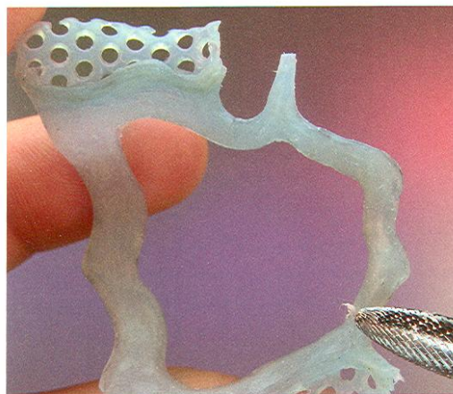
Abb. 3 Zum Ausarbeiten des polymerisierten Metacon-Waxes sind kreuzverzahnte Kunststofffräsen sehr gut geeignet
