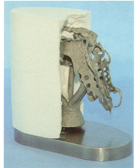
Abb. 7 Ein sauberer Dreier-Guss, zum Beweis nur halb ausgebettet. Die Ersparnis an Einbettmasse ist offensichtlich, es wurde aber auch nur ein Gusskegel erzeugt.
