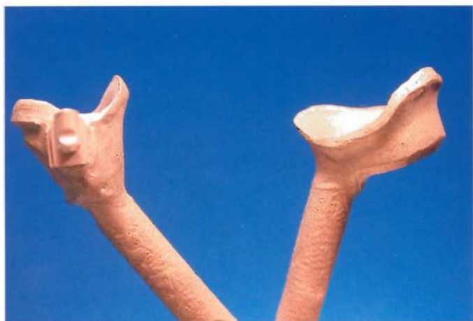
Abb. 26 Die gusstechnische Umsetzung zeigt perfekte Metalloberflächen.
