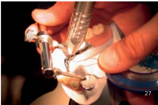
Abb 27 und 28 In den meisten Fällen muss von Anfang an mit Zulegedraht geschweißt werden.
