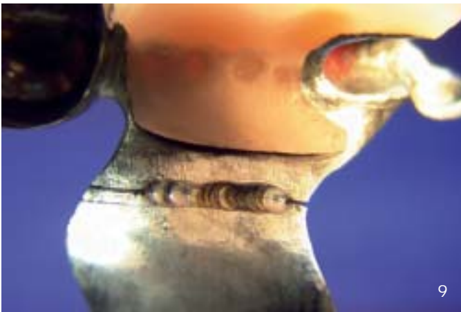
Abb. 9 und 10 Eine alte Co-Cr-Teilprothese wurde mit einer Scheibe durchtrennt und mit falscher Impulsdauereinstellung (3 ms) geschweißt.
