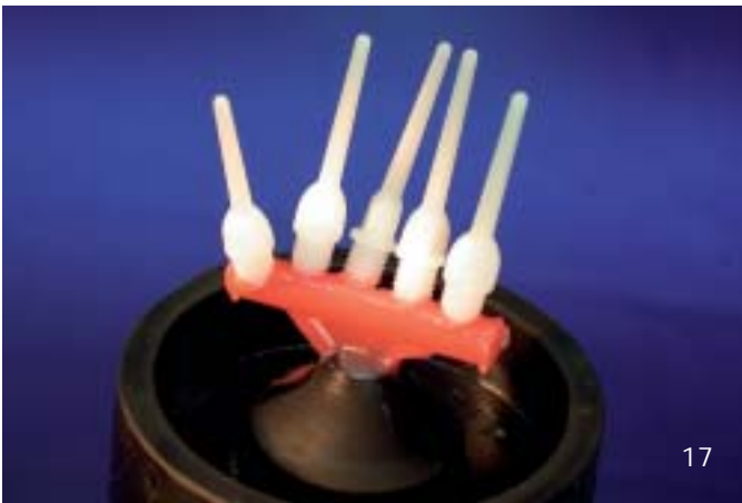
Abb. 17 bis 20 Die mitgelieferten Plastikspitzen aus rückstands-frei verbrennendem Kunststoff können mit den, im Labor norma-lerweise verwendeten Legierungen, gegossen werden.
