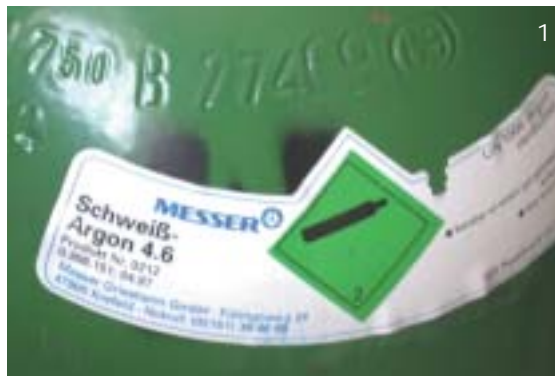
Abb. 1 Um erfolgreich zu Schweißen benötigt man Argon 4,6 (entspricht einer Reinheit von 99,996 %) oder höher.
