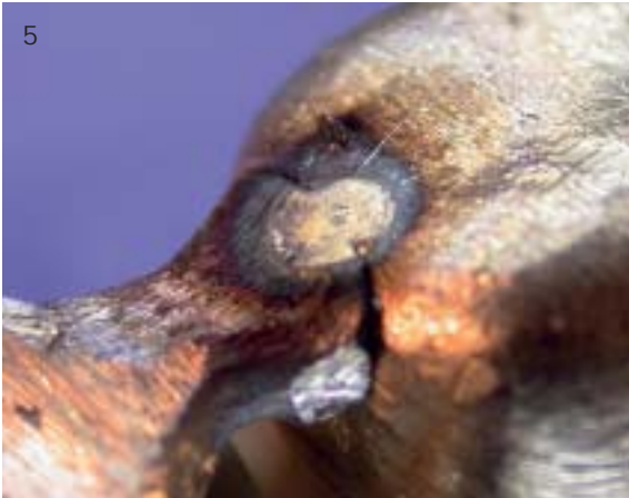
Abb. 5 Nach dem Sandstrahlen nicht abgedampft. Die verbliebenen Aluminiumoxidpartikel im Bereich des Schweißpunktes sind verbrannt.
