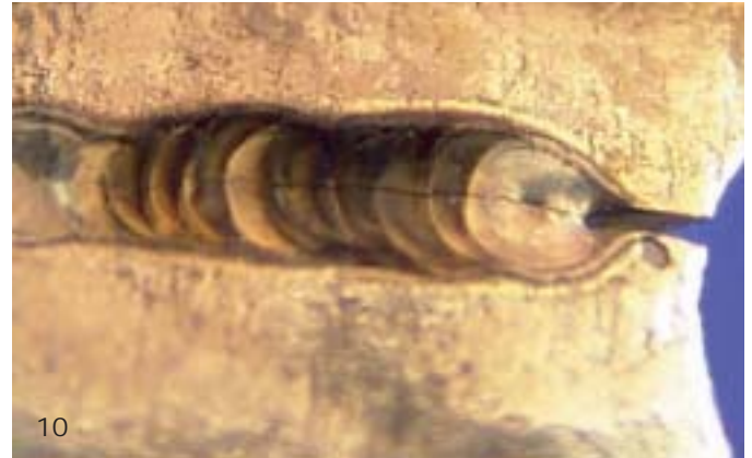
Abb. 9 und 10 Eine alte Co-Cr-Teilprothese wurde mit einer Scheibe durchtrennt und mit falscher Impulsdauereinstellung (3 ms) geschweißt.
