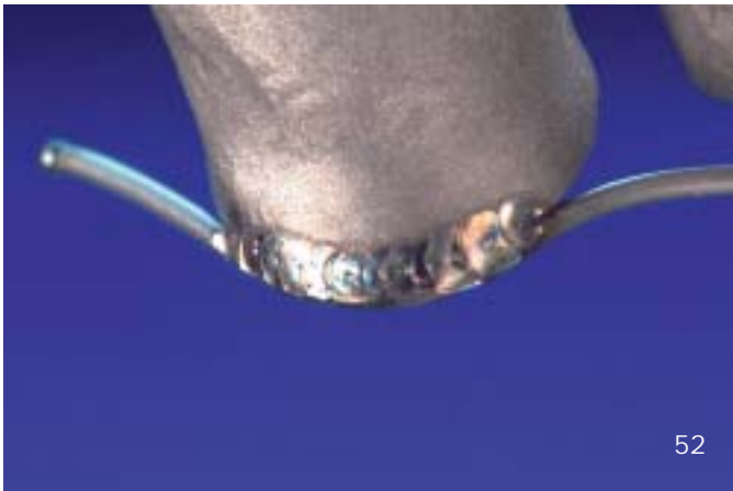
Abb. 52 bis 54: Die Abbildung 52 zeigt deutlich, dass – obwohl der Draht vollständig an den Rand geschweißt ist, der äußere Rand des Drahtes jedoch unberührt bleibt. Dies wird durch die korrekte Einstellung der Parameter, gutes Zielen und ruhige Hände erreicht.
