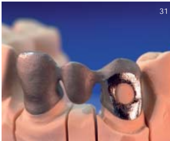
Abb. 31 Schon der erste Schweißimpuls an einem Loch mit dünner Wandstärke macht das Loch eher viel größer, anstatt es zu schließen.
