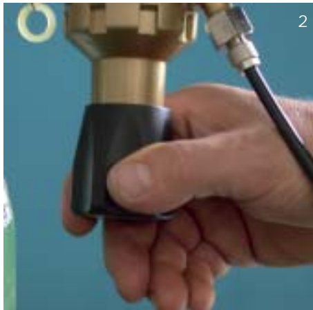
Abb. 2 Die Gasdurchflussmenge (l/min) wird mit dem Ventil an der Unterseite des Druckminderers eingestellt und auf der rechten Messuhr angezeigt.
