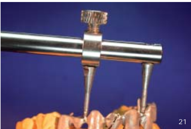
Abb. 21 Der Abstand zwischen den Spitzen kann individuell eingestellt werden, abhängig von den jeweiligen Anforderungen des Werkstücks.
