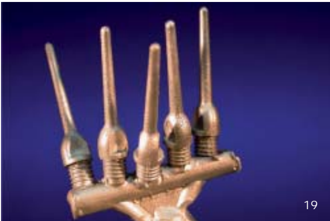
Abb. 17 bis 20 Die mitgelieferten Plastikspitzen aus rückstands-frei verbrennendem Kunststoff können mit den, im Labor norma-lerweise verwendeten Legierungen, gegossen werden.
