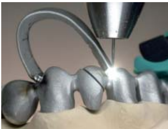
Abb. 20 Der gegossene Balken wird mit einem oder zwei Schweißimpulsen an jedem der zu verbindenden Teile befestigt. Nachdem das Werkstück zusammengesweißt worden ist, lässt sich der Balken leicht mit bloßer Hand „abknicken“.
