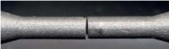
Abb. 5 Zum Löten vorbereitete Probe für den Festigkeitstest nach Norm EN 29333 mit Simulation der Spaltdivergenz. Die Spaltdivergenz ist durch den Schnitt entstanden, der die Verformung der Brücke ausgleicht und das „Schaukeln der Brücke“ einstellt.
