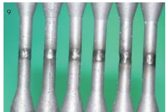
Abb. 9 Vollständig geschweißter Prüfkörper für den Standardtest
