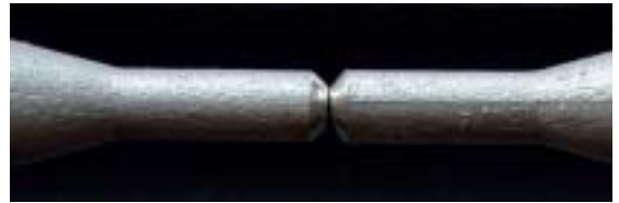
Abb. 7 Die abgeschrägten Ränder ermöglichen es, den Spalt voll zu durchschweißen, ohne die Legierung durch zu viel Energie zu überhitzen.
