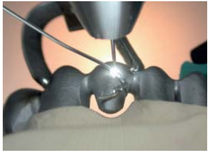
Abb. 16 Von Anfang an wird Schweißdraht aus der gleichen Legierung wie das Werkstück verwendet.
