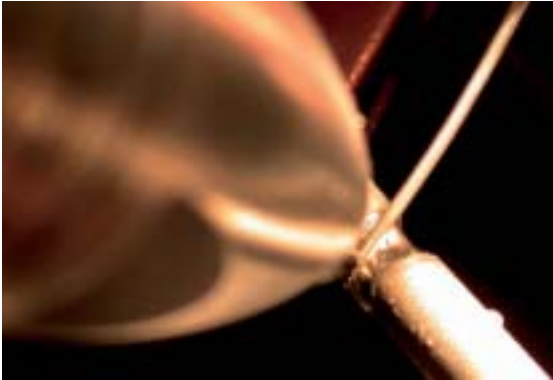
Abb. 8 Der abgeschrägte Bereich wird mit artgleichem Zulegematerial aufgefüllt.
