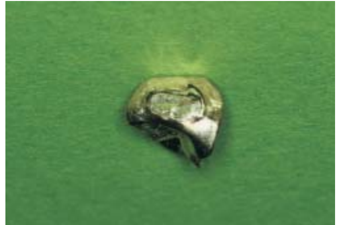
Abb. 2 Verfärbter und korrodierter Lötkontaktpunkt eines Goldinlays
