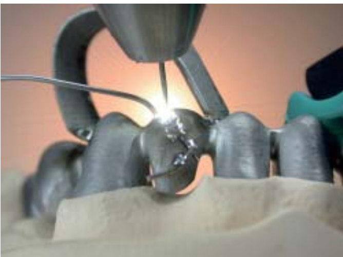
Abb. 15 Schrägschnitt durch ein Brückenglied. Der Spalt ist relativ breit und muss mit Schweißdraht gefüllt werden. Der am Oberteil aufgeschweißte gebogene Balken sichert die Position und verhindert eine Verdrehung beim Schweißen.
