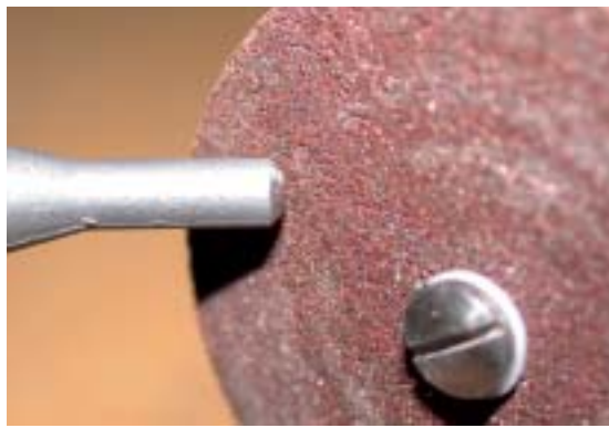
Abb. 7 Die abgeschrägten Ränder ermöglichen es, den Spalt voll zu durchschweißen, ohne die Legierung durch zu viel Energie zu überhitzen.
