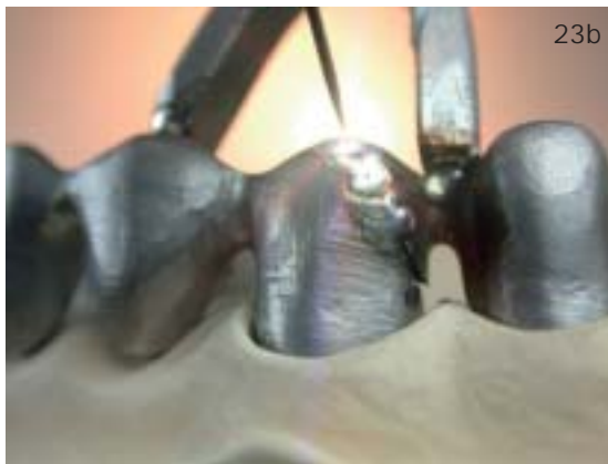
Abb. 23a bis 23d: Eine sichere Methode, um den Verzug „zu besiegen“. Ein richtig platzierter Trennschnitt (durch die Krone), was weniger Schweißenergie bedeutet, in Kombination mit dem geeigneten Schweißdraht und einem festen Gussbalken als „Haltevorrichtung“ um die Position der zu schweißenden Teile zu fixieren.
