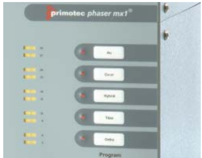
Abb. 14 Voreingestellte aber individuell veränderbare Programme des primotec phaser mx1 für Gold, Kobalt-Chrom, Hybridschweißungen (Gold an CoCr), Titan und KFO
