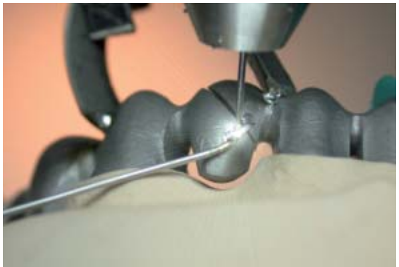
Abb. 21 Quer über dem Spalt befestigter Schweißdraht. Eine zusätzliche Sicherheitsmaßnahme, die aber meistens eher überflüssig ist.
