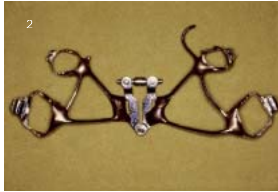
Abb. 1 Eine stumpfe, grau verfärbte und porös erscheinende Lötverbindung an einer CoCr-Teilprothese, die etwa ein Jahr lang in situ gewesen war.
