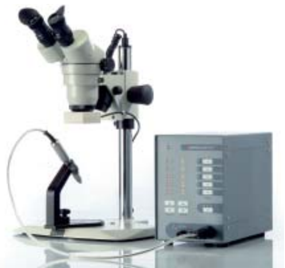
Abb. 12 Der primotec phaser mx1 inkl. sive Steuergerät, Zoom-Mikroskop und Handstück
