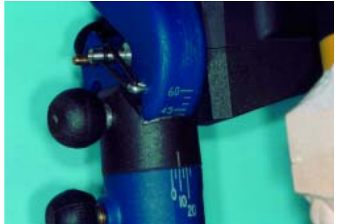
Abb. 3 Das korrekte Einstellen der Kondylenbahnneigung und des Bennettwinkels sind die Basis für eine korrekt angefertigte Schiene
