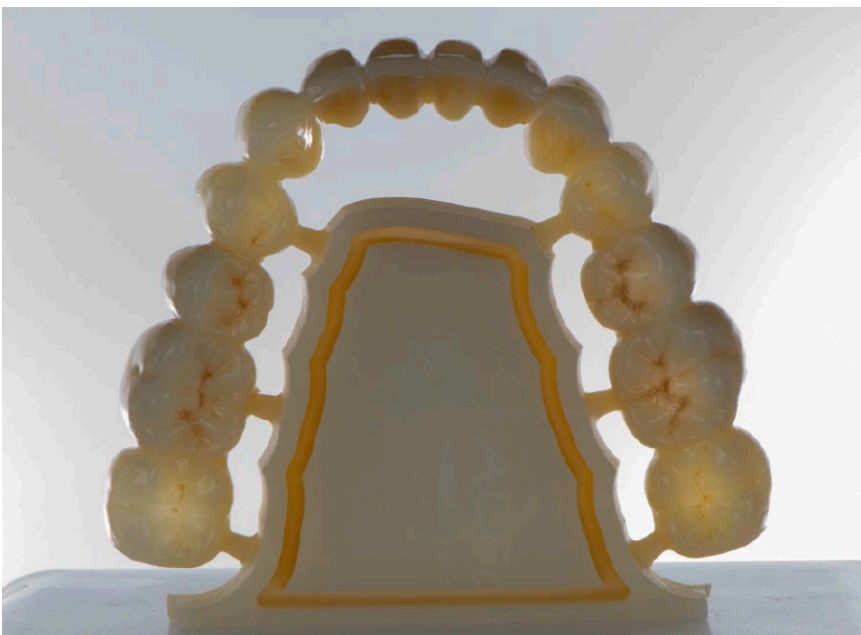
Die Risszähigkeit von PREMIO Alegria PRO liegt im Zahnhalsbereich bei > 3,5 \text{ MPa } \sqrt{\text{m}} und steigert sich zur Schneide hin auf > 5 \text{ MPa } \sqrt{\text{m}}
