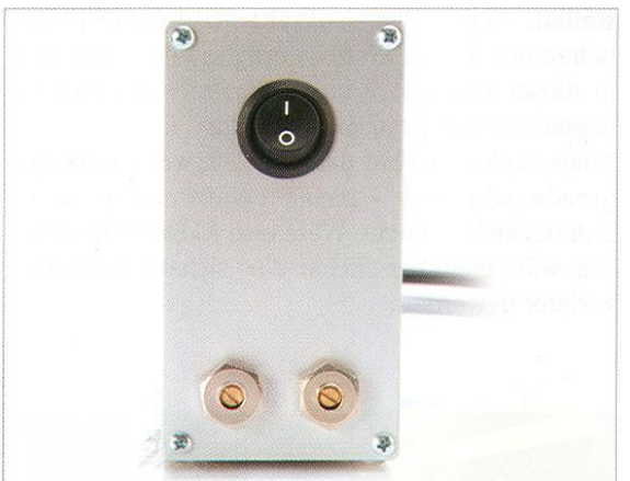
Abb. 8 Elektronische Magnetventile in der Steuerbox des Twister Two
