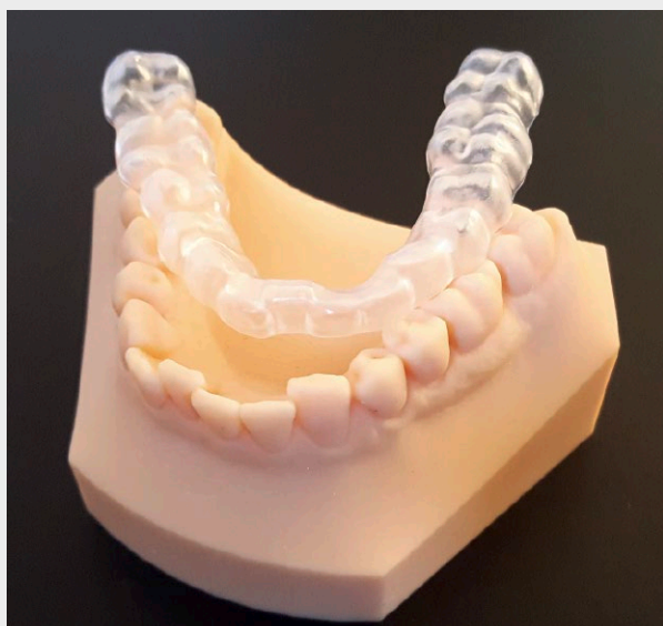
01 Gefräste Premiotemp Clear Flex Schiene: Unpolierter Zustand direkt nach dem Verschleifen der Haltestifte. Das Material hat eine gewisse Grundflexibilität, die die Schiene im normalen Gebrauch sehr bruchsicher macht.
