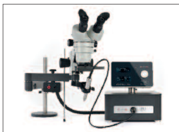
Abb. 1 Mit den phaser Geräten von primotec wird dentales Schweißen insbesondere bei kritischen Legierungen materialgerechter
