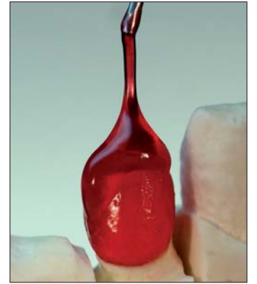
Abb. 3: Das thixotrope Verhalten des Gels vereinfacht das Modellieren und ermöglicht eine flexible Anwendung.
