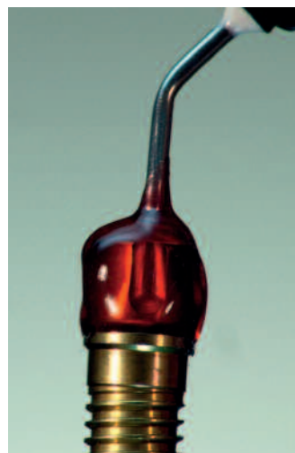
Abb. 7 Durch die abgestimmte Viskosität und das thixotrope Verhalten lässt sich das Gel punktgenau auftragen
