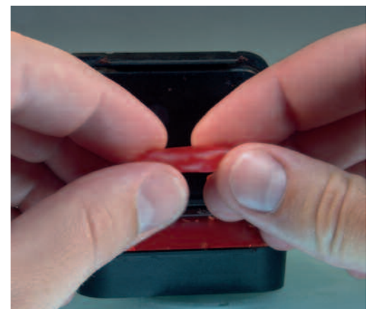
Abb. 13 Eine Konsistenz ähnlich weicher Knete und nicht klebrig – das Material lässt sich einfach mit den Fingern formen
