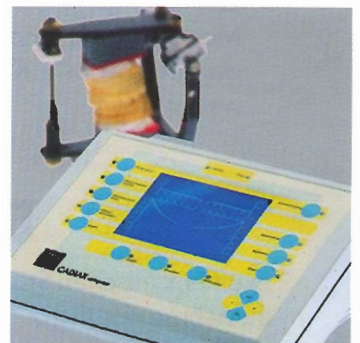
Abb. 2: Aufzeichnung der Unterkieferbewegungen zur Ermittlung der horizontalen und transversalen Kondylenbahn-Neigung
