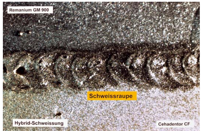
Abb. 4 Makroskopische Wiedergabe der Schweißraupe einer „Hybridschweißung“ zwischen einer Modellguss- („Remanium GM 900“) und einer Edelmetalllegierung („Cehadentor CF“)
