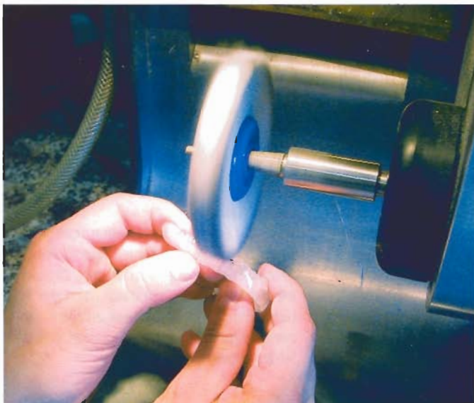
Abb. 21 Hochglänzende Oberflächen sind sehr leicht durch das Polieren mit einem Baumwollschwabbel und geeigneten, für die Kunststoffpolitur vorhandenen Polierpasten zu erzielen. Eine weitere Möglichkeit, hochglänzende Oberflächen zu erhalten, besteht auch darin, diese Flächen mit einem speziellen Oberflächenlack der Fa. primotec zu beschichten und zu polymerisieren.
