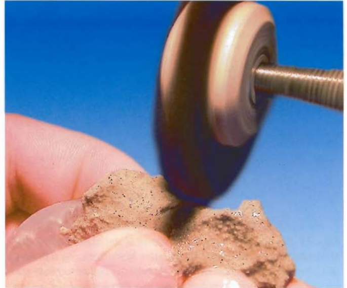
Abb. 20 Die Vorpholitur erfolgt, wie gewohnt, mit Bimsstein und einer Bürste und schließt in der feinen Vorpholitur mit einer Ziegenhaarbürste kratzfrei ab.
