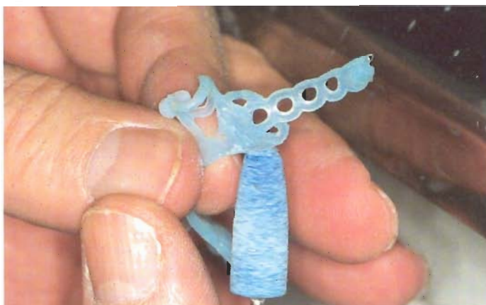
Abb. 9 Ausarbeiten der Modellation vor dem Guss mit Gummipolierern
