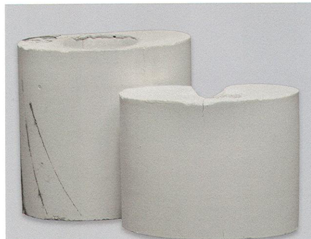
Abb. 25 Verschiedene Muffelhöhen für unterschiedliche Höhe und Größe der Modellgüsse
