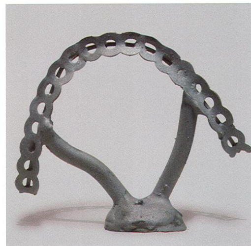
Abb. 28 Das Gussobjekt nach dem Abstrahlen
