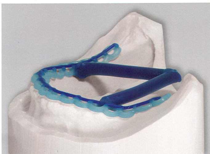
Abb. 27 Anstiftung für den Vertikalguss
