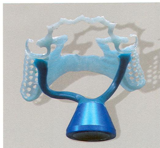
Abb. 16 Beispiel Horizontalguss: Hierfür waren zirka 400 Gramm Einbettmasse nötig, ganz abgesehen von der Aufheizzeit! Es war einmal, ...
