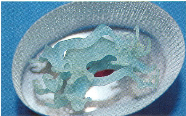
Abb. 23: Drei Gußobjekte in einer metaring Muffel.
