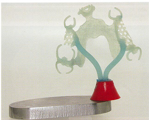
Abb. 27: Der metaclitic Gußtrichter ist magnetisch,...
