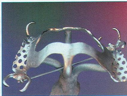
Abb. 14: An einem solchen Guss muss nicht mehr viel ausgearbeitet werden.
